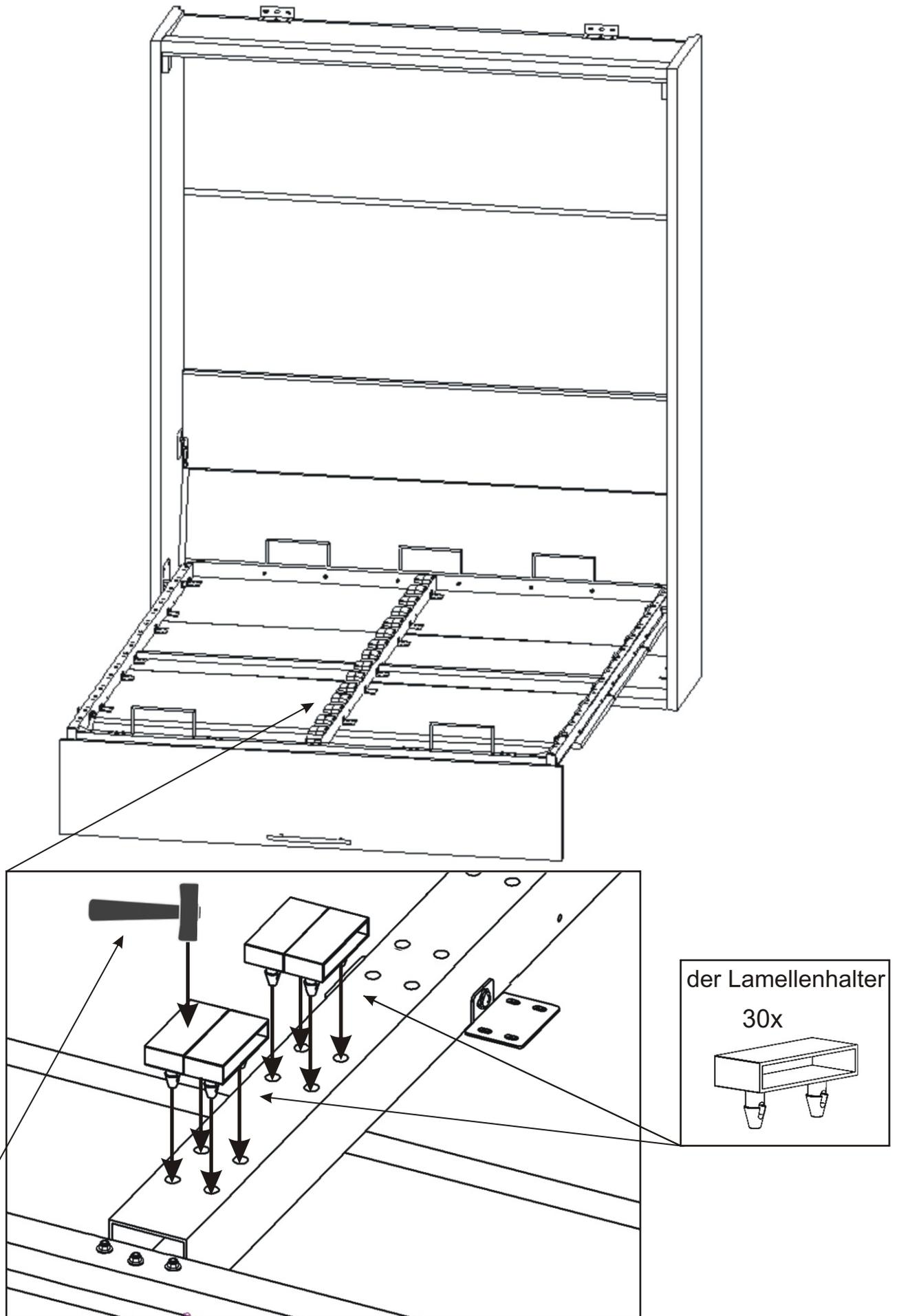
*Klopfen Sie vorsichtig auf die Lamellenhalter. Verwenden Sie den keinen Metallhammer, um eine Beschädigung des Halters zu vermeiden.*
