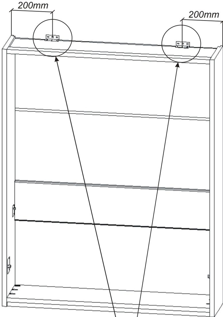
*Die Anzahl und die Art der Dübeln muss durch die Art der Wand bestimmt werden.*
