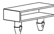
*Klopfen Sie vorsichtig auf die Lamellenhalter. Verwenden Sie den keinen Metallhammer, um eine Beschädigung des Halters zu vermeiden.*
