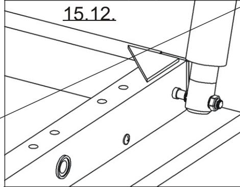
*Befestigen Sie den großen Kolben am Rahmen und sichern Sie ihn mit einer Mutter. Ziehen Sie die Mutter nicht fest, der Kolben muss sich bewegen können.*
