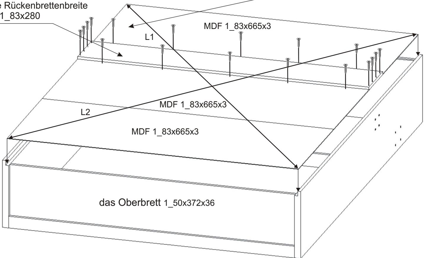
Messen und richten Sie die Diagonalen aus L1=L2, bevor Sie die Rückseite des Schrankes anbringen.
