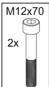
**Ziehen Sie die Schraube M12x70 nicht ganz fest, sondern lassen Sie einen Spalt von ca. 1-2 mm zwischen Schraubenkopf und Unterlegscheibe. Andernfalls besteht die Gefahr einer irreparablen Beschädigung des Rahmens !!!**
