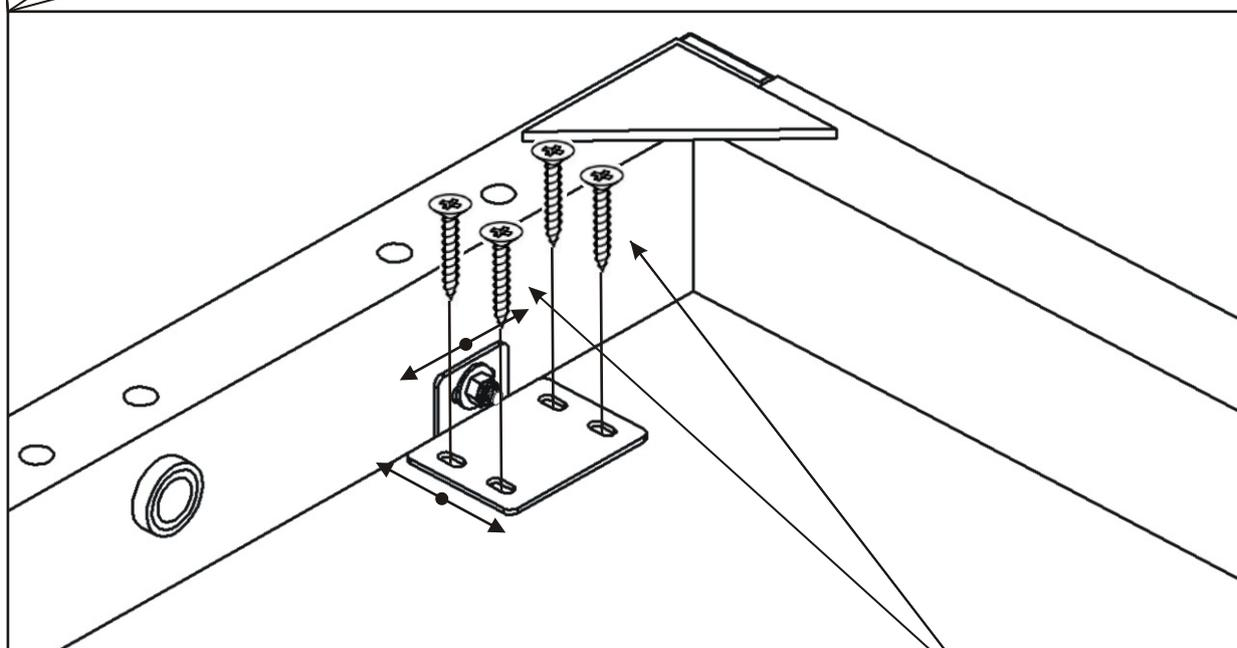
*Befestigen Sie den Bettrahmen mit den Schrauben an der Tür.
