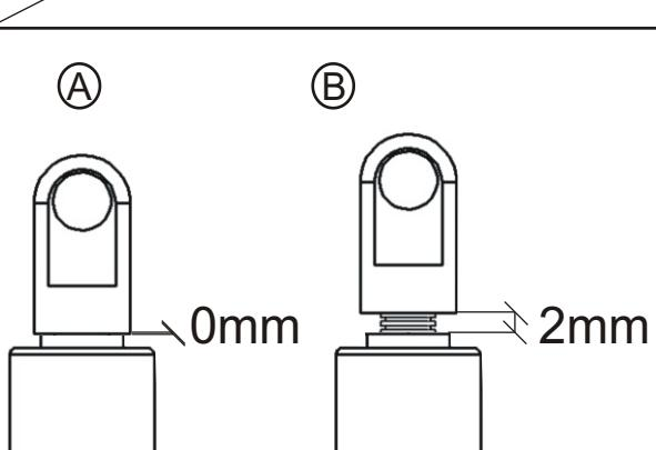
Zur Montage des Klappbettes verwenden Sie die Kolben, die als in der Abbildung A eingestellt sind.
