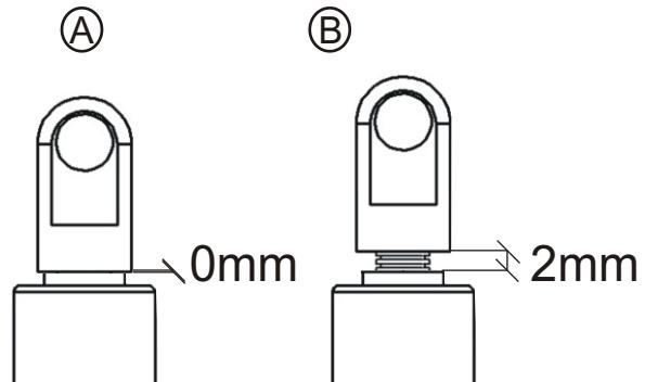
Zur Montage des Klappbettes verwenden Sie die Kolben, die als in der Abbildung A eingestellt sind.
