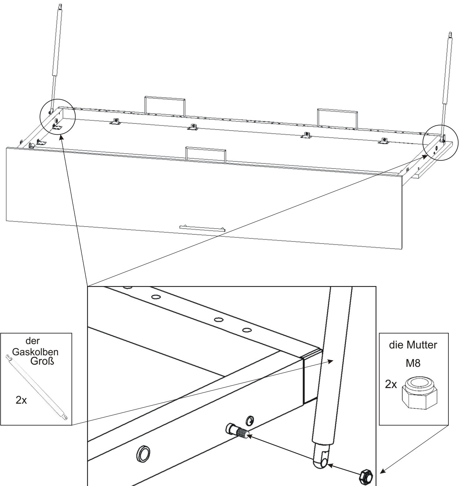
Der große Kolben ist am Rahmen zu montieren und mit einer Mutter zu sichern.
