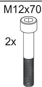
Ziehen Sie die Schraube M12 × 70 nicht vollständig fest. Lassen Sie zwischen Schraubenkopf und Unterlegscheibe ein Spiel von ca. 1–2 mm, um die notwendige Beweglichkeit zu gewährleisten. Wird die Schraube zu fest angezogen, besteht die Gefahr einer irreparablen Beschädigung des Betrahmens!
