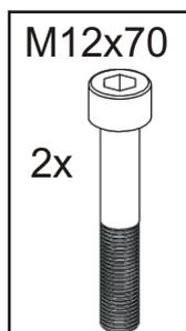
Ziehen Sie die Schraube M12 × 70 nicht vollständig fest. Lassen Sie zwischen Schraubenkopf und Unterlegscheibe ein Spiel von ca. 1–2 mm, um die notwendige Beweglichkeit zu gewährleisten. Wird die Schraube zu fest angezogen, besteht die Gefahr einer irreparablen Beschädigung des Bettrahmens!
