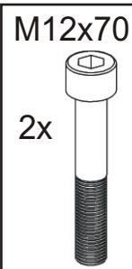
Ziehen Sie die Schraube M12 × 70 nicht vollständig fest. Lassen Sie zwischen Schraubenkopf und Unterlegscheibe ein Spiel von ca. 1–2 mm, um die notwendige Beweglichkeit zu gewährleisten. Wird die Schraube zu fest angezogen, besteht die Gefahr einer irreparablen Beschädigung des Bettrahmens!
