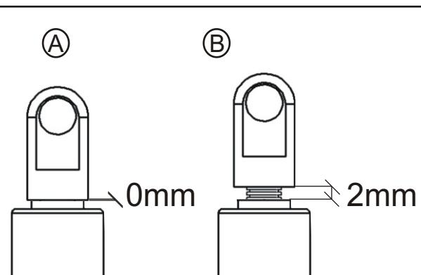
Zur Montage des Klappbettes verwenden Sie die Kolben, die als in der Abbildung A eingestellt sind.
