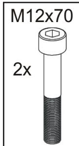
Ziehen Sie die Schraube M12 × 70 nicht vollständig fest. Lassen Sie zwischen Schraubenkopf und Unterlegscheibe ein Spiel von ca. 1–2 mm, um die notwendige Beweglichkeit zu gewährleisten. Wird die Schraube zu fest angezogen, besteht die Gefahr einer irreparablen Beschädigung des Bettrahmens!
