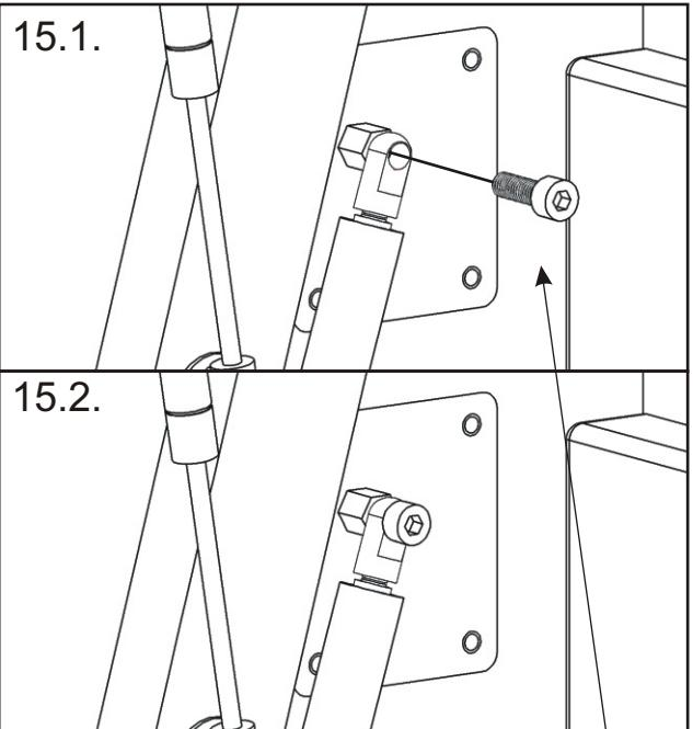
Die Schraube darf nicht vollständig festgezogen werden, da sie ein geringes Spiel für die Drehbewegung haben muss. Andernfalls besteht die Gefahr einer irreparablen Beschädigung des Kurbels!
