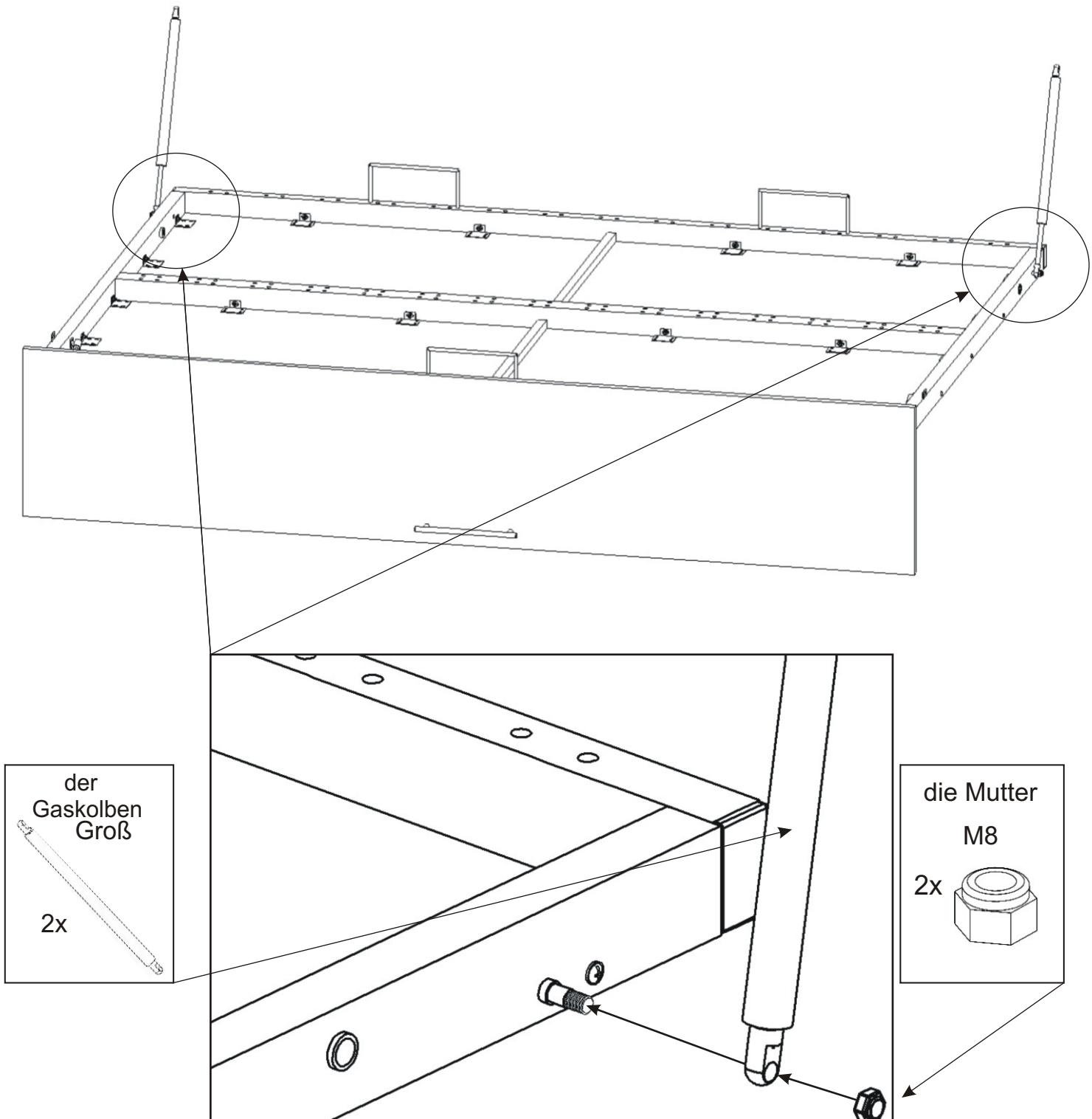
Der große Kolben ist am Rahmen zu montieren und mit einer Mutter zu sichern.
