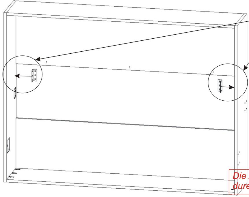
*Die Anzahl und die Art der Dübeln muss durch die Art der Wand bestimmt werden.*
