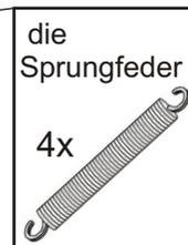
Es ist schwieriger, die Feder anzuziehen. Sie müssen den Lagerplatz vollständig öffnen. Setzen Sie zuerst die Feder in das hintere Loch ein. Stecken Sie das andere Ende der Feder in das vordere Loch. Verwenden Sie dazu eine Kombizange. Das gleiche Verfahren wird auf der anderen Seite sein.
