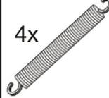
Es ist schwieriger, die Feder anzuziehen. Sie müssen den Lagerplatz vollständig öffnen. Setzen Sie zuerst die Feder in das hintere Loch ein. Stecken Sie das andere Ende der Feder in das vordere Loch. Verwenden Sie dazu eine Kombizange. Das gleiche Verfahren wird auf der anderen Seite sein.
