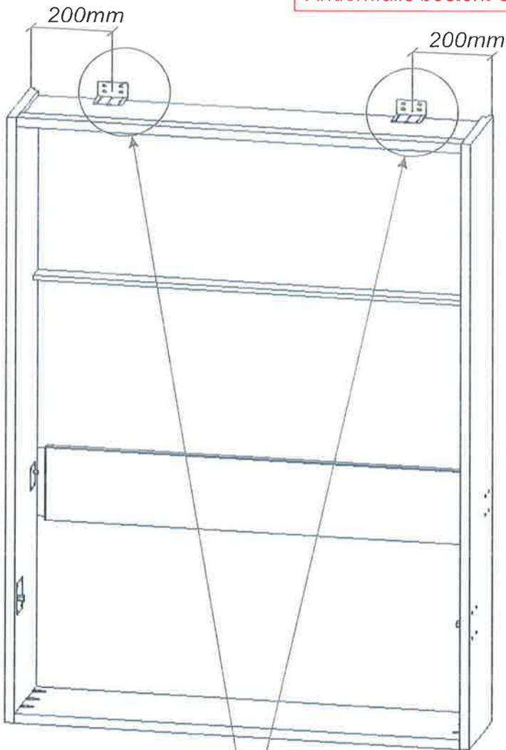
*Die Anzahl und die Art der Dübeln muss durch die Art der Wand bestimmt werden.*
