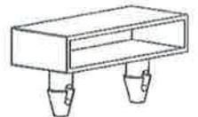
*Klopfen Sie vorsichtig auf die Lamellenhalter. Verwenden Sie den keinen Metallhammer, um eine Beschädigung des Halters zu vermeiden.*
