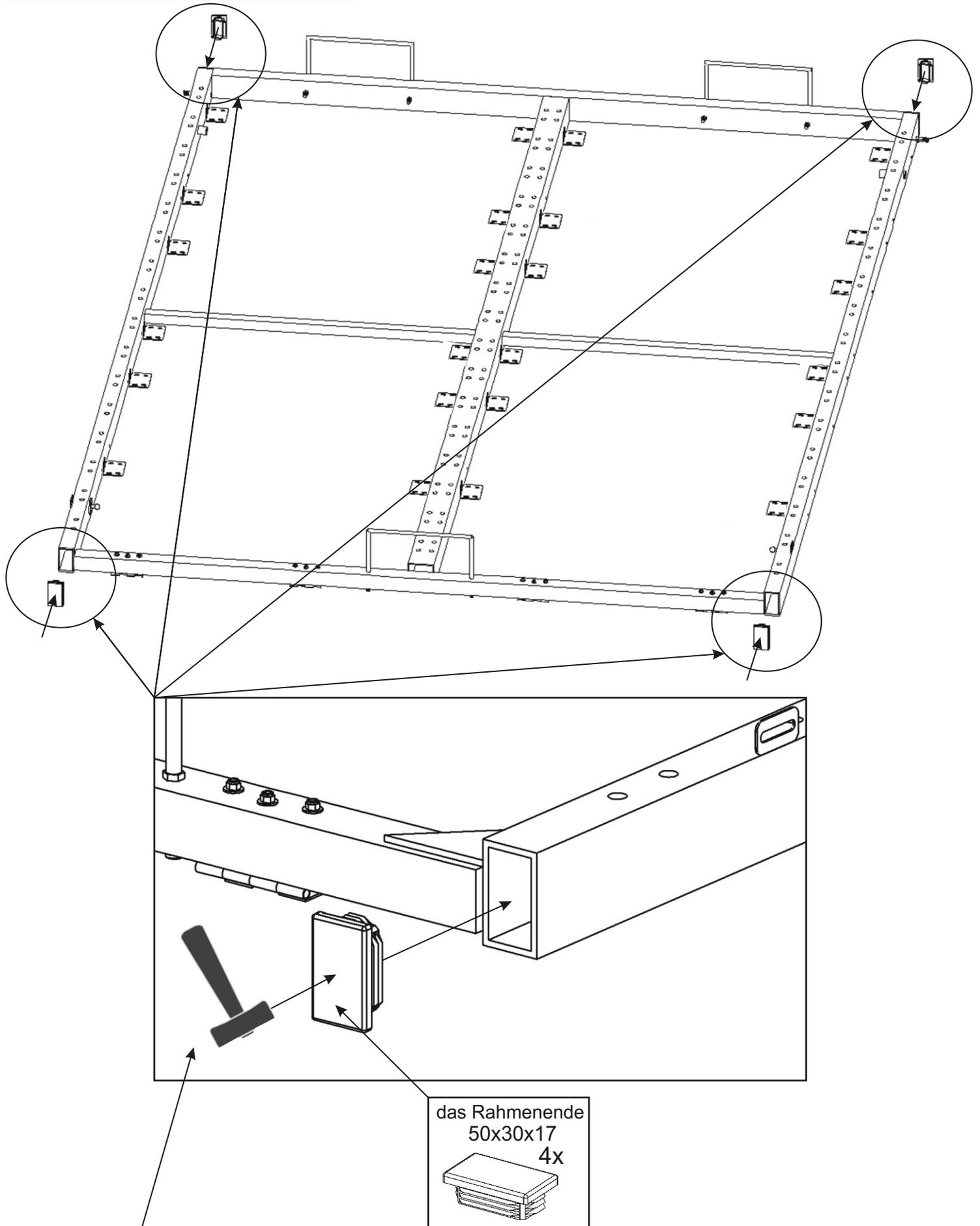
Klopfen Sie vorsichtig auf das Endstück. Verwenden Sie der keinen Metallhammer, um eine Beschädigung das Endstückes zu vermeiden.
