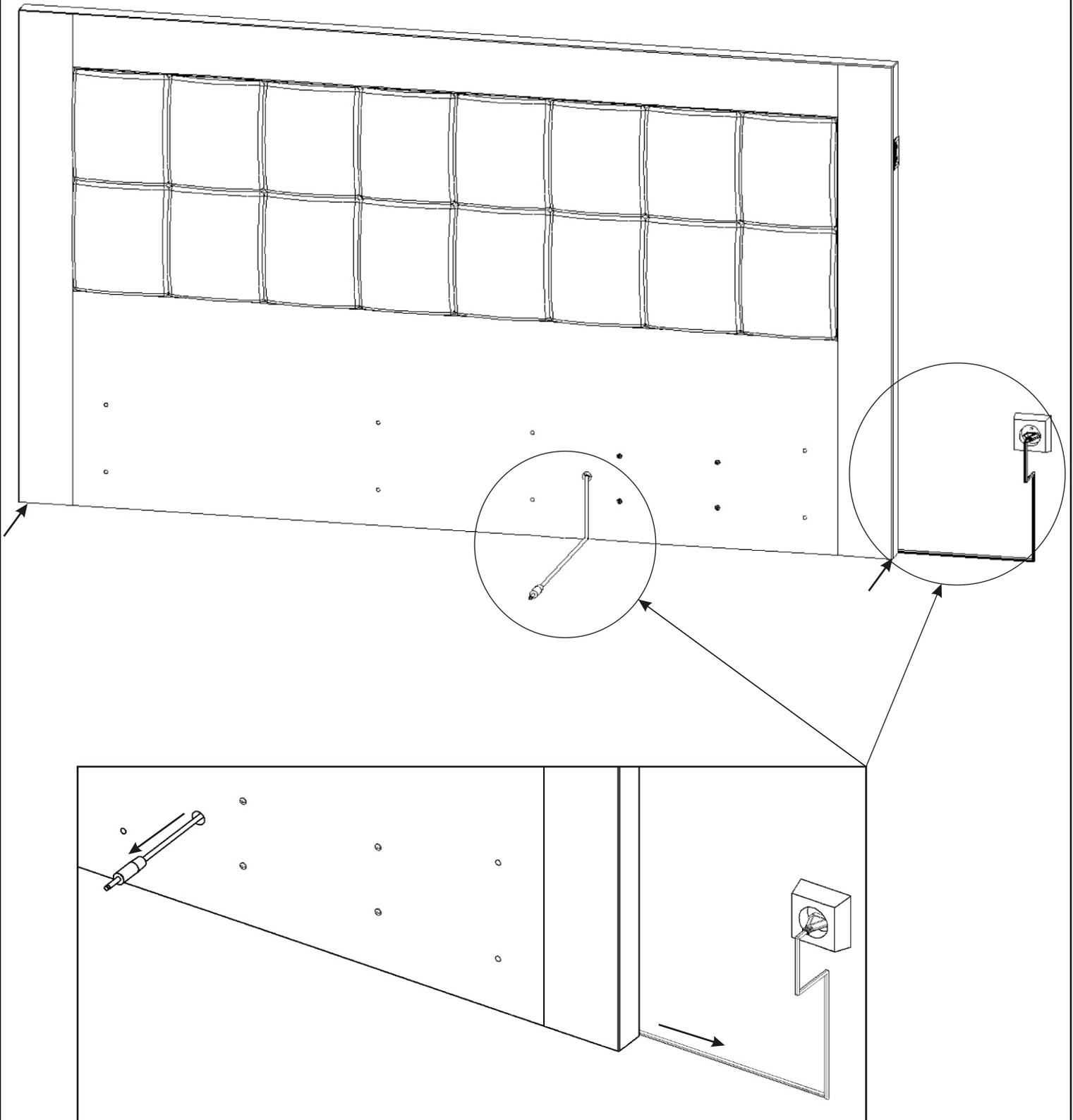
Ziehen Sie das Motorkabel durch die Kopfteilöffnung.
