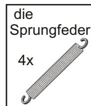
Es ist schwieriger, die Feder anzuziehen. Sie müssen den Lagerplatz vollständig öffnen. Setzen Sie zuerst die Feder in das hintere Loch ein. Stecken Sie das andere Ende der Feder in das vordere Loch. Verwenden Sie dazu eine Kombizange. Das gleiche Verfahren wird auf der anderen Seite sein.
