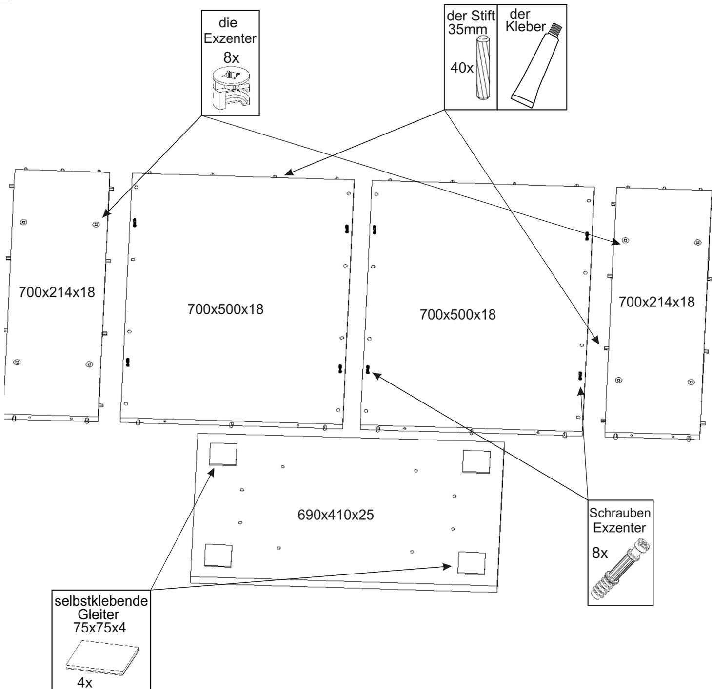
Kleben Sie selbstklebende Gleiter auf die Unterseite der Tischplatte.
