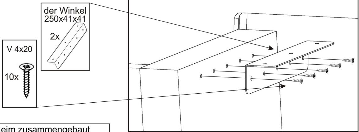
Die Bank kann auch ohne Leim zusammengebaut werden, im Falle einer Verleimung ist es nicht möglich, sie ohne Beschädigung zu demontieren.
